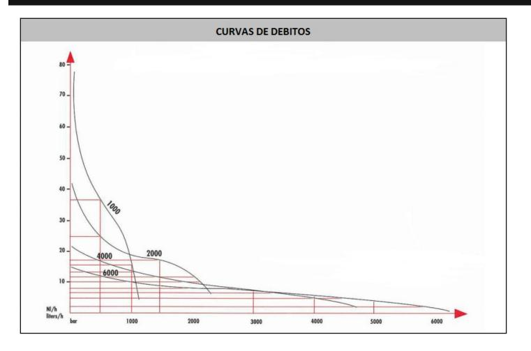
As medidas de débitos foram efectuadas com água a uma temperature de 20°C.
